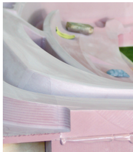
Komplettes Werkzeugbau-Leistungsspektrum: hier das Ureol-Modell eines Caravan-Armaturenbretts.
