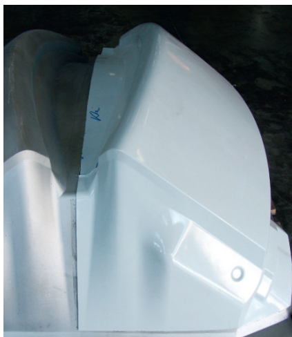
Auf der Eima gefertigte Vakuumtiefziehform aus Aluminium mit einem gefertigten Prototyp.
