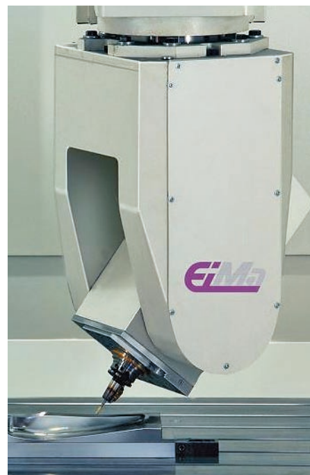
4: Mit einem Harmonic Drive Getriebe ausgerüsteter Fräskopf
